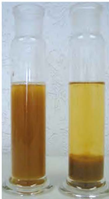
Standardpektinase 10 ml/100 l Trenolin® Frio DF 10 ml/100 l Abb. 2: Enzymierung von Rieslingmost nach 1,5 Stunden bei 5 °C.
