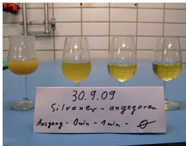
Abb. 5: Trübungsverlauf am Beispiel eines angegorenen Mostes; v. l. n. r.: 1. Unfiltrat; 2. Filtrat nach 0 min; 3. Filtrat nach 1 min; 4. Gesamtrübung im Filtrattank
