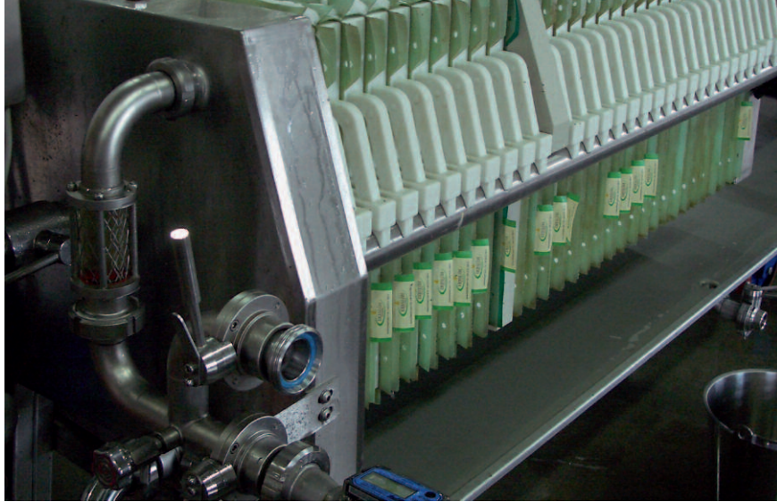
Abb. 2: Kammerfilterpresse mit monofilem eSan-Tuch
