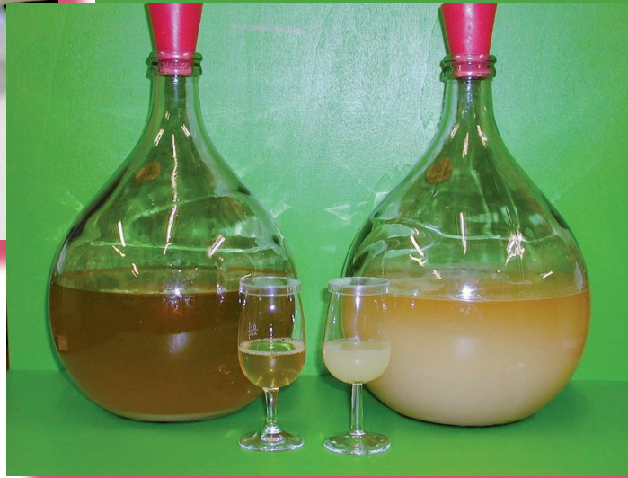
Durchführung eines Klärversuchs im 10 l-Maßstab.
